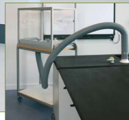
▲ Mobilt aftrækskab giver mulighed for sikker udførelse af mere "eksplosive" forsøg. Tilkobles til eksisterende procesventilation.
